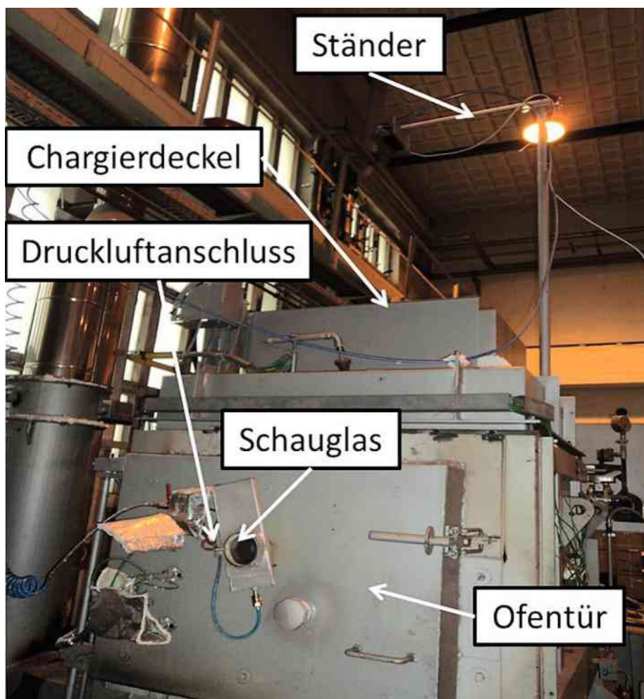
Das am IFUM in Hannover ausgewählte Kamerasystem fürs Vermessen der Höhenänderungen im Aluminiumofen wurde im Rahmen von Versuchen an der TU in Freiberg erprobt. Hierzu wurde zunächst die optimale Kameraposition über dem Chargierdeckel des Ofens ermittelt, in der die Kamera anschliessend fest positioniert wurde. Bild: ZPF GmbH + IFUM
